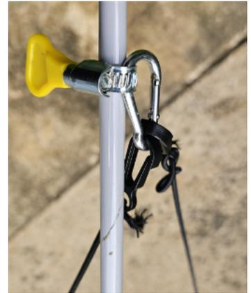
**Bild 9** Beispiel für Elementbefestigung am Tragmast
