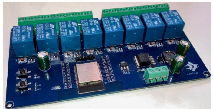
*8-fach Relaisplatine mit ESP32*
