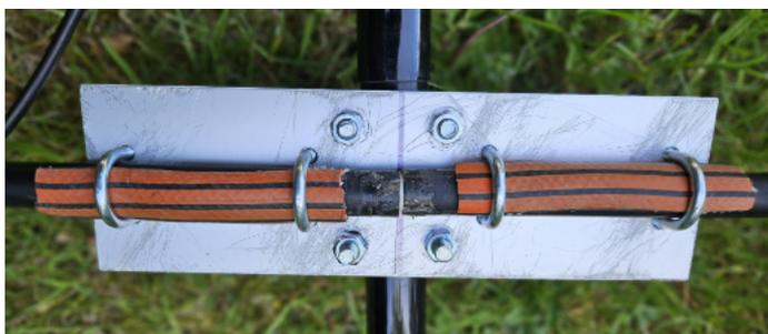
**Bild 3** Bei der Mast-Boom-Halterung in der „heavy duty“-Variante sind die Rohrbügel mit einer Gummimanschette zu unterlegen
