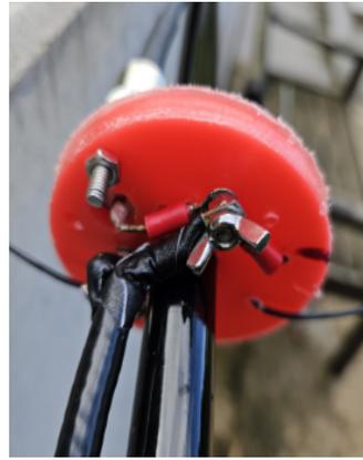
**Bild 6/7** Rückseite der Einspeisung mit weitergeführtem Koaxialkabel, einfache Befestigung mit Flügelmuttern
