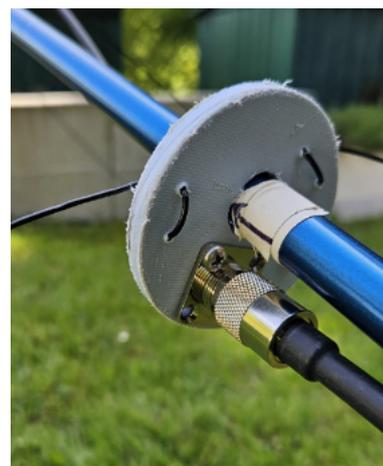
**Bild 5** Einspeisung der Antenne über eine SO-239-Buchse
