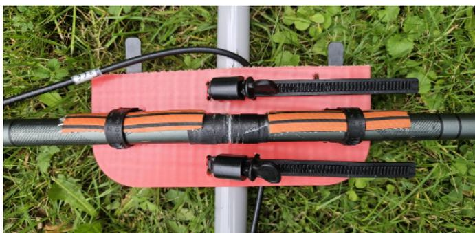
**Bild 2** Mast-Boom-Halterung „light“ aus Kunststoff.
