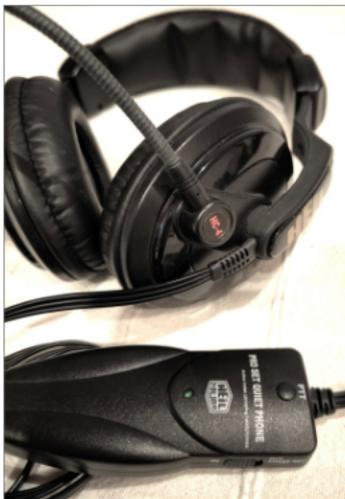
Das Heil Quiet Phone hat die Schaltung für das NC inklusive zugehöriger Batterien in einem kleinen Kästchen, was in den Zuleitungen zum Headset integriert ist. Daran befinden sich auch die entsprechenden Bedienelemente. Das NC funktioniert gut. Zum Tragekomfort gilt gleiches wie beim Heil Pro-Set-Elite. Ein Nachteil ist darin zu
