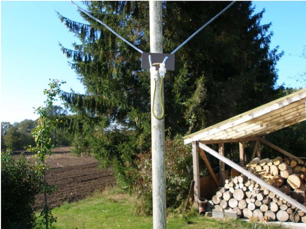
**Abbildung 11: Schleifenverlängerung als Stub**
