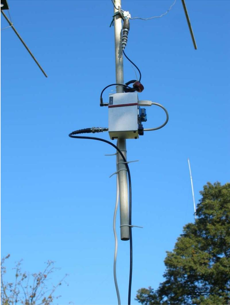
**Abbildung 5: Anordnung Analyzer DG8SAQ**
