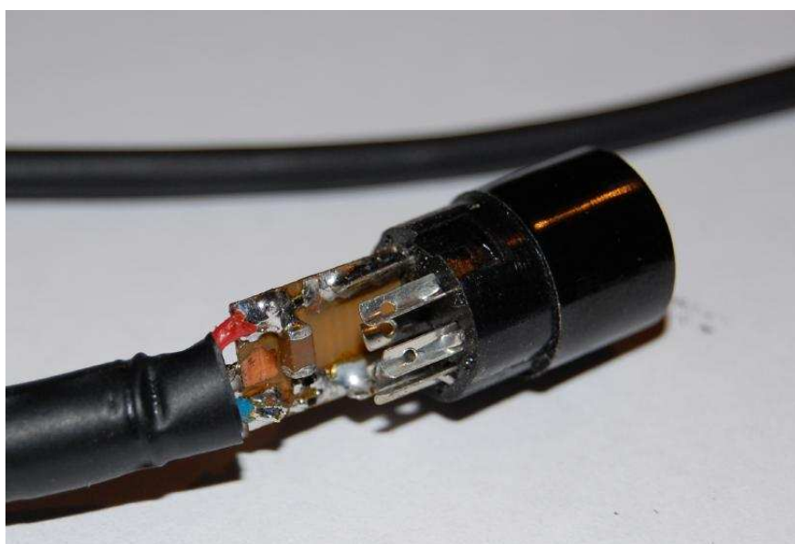
Abb. 4: Foster 8-Pin-Mikrofonstecker mit montierter Platine
