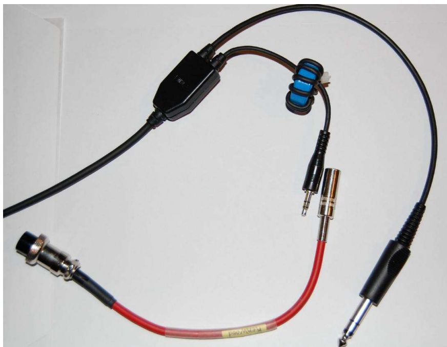
Abb. 3: Modifiziertes Y-Kabel mit Adapter für Kenwood
