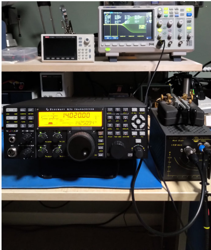
Bild 1 Messaufbau: K3S #10925 am Oszi
