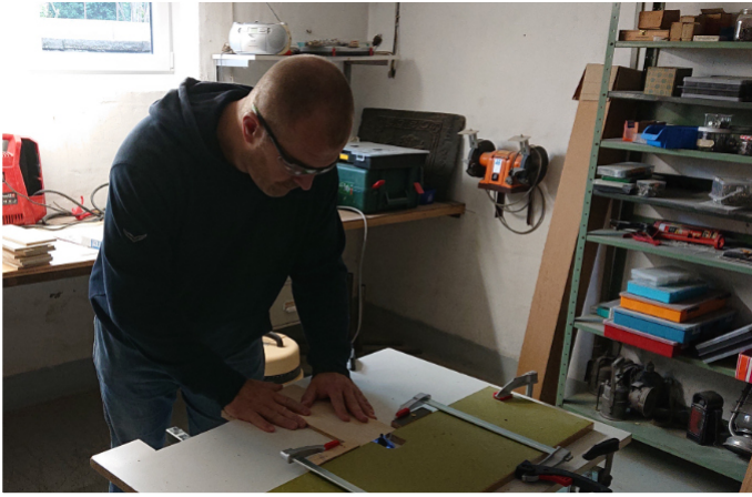
Präsident@Work: Fräsarbeiten an den Trägerplatten
