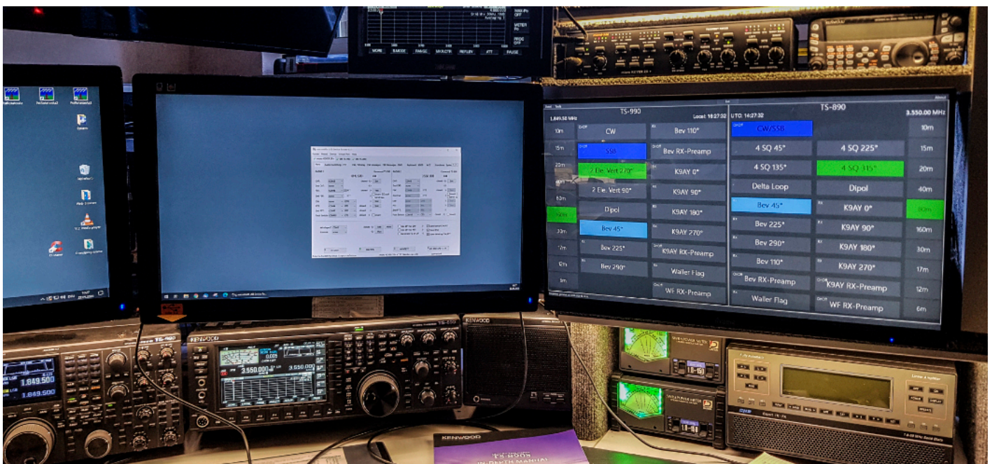
Bild 1 Der Touchscreen fügt sich auf dem Stationstisch hinsichtlich Größe und Bedienbarkeit gut ein. Der 21-Zoll Touchscreen (im Bild rechts) zeigt jeweils aktive Antennen nach dem Berühren der virtuellen Tasten grün bzw. blau eingefärbt. Hinzu kommen Infos mit den Frequenzen beider Radios und eine Bandanzeige rechts und links.
