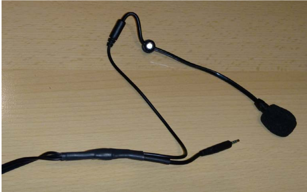
Bild 5 Fertig konfektioniertes Mikrofon mit Kabel
