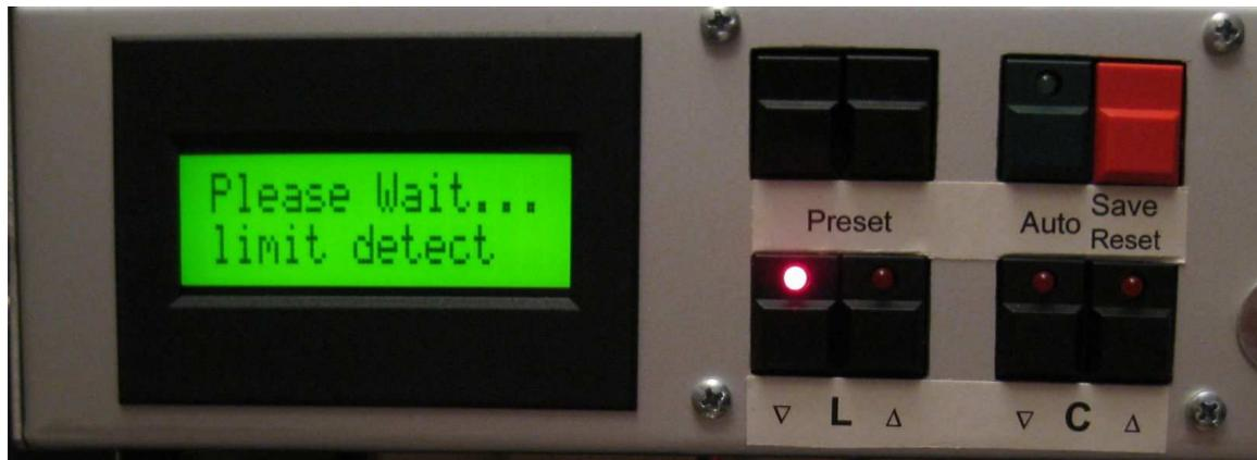
Nachdem alle Motoren die Nullposition erreicht haben, werden sie im Automatik-Modus nacheinander auf die gespeicherten Werte des vor dem Abschalten angewählten Bandsegmentes gefahren. Die Bewegung der Motoren wird dabei über einen blinkenden Cursor in der rechten unteren Ecke signalisiert.
