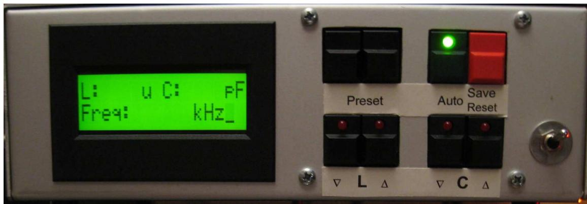
Nach dem Erreichen der gespeicherten Werte des zuletzt angewählten Bandsegmentes erscheinen diese Werte am Display und der blinkende Cursor verschwindet. Der Tuner ist jetzt betriebsbereit.
